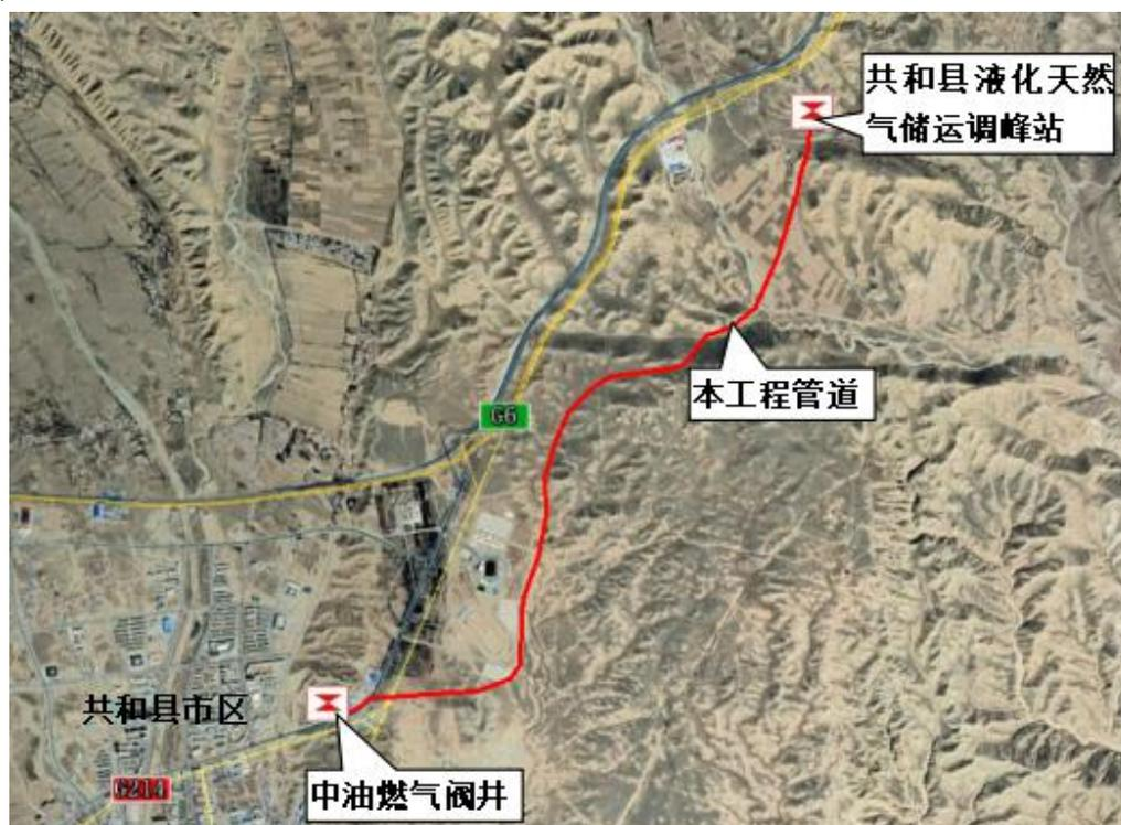
图 1 外输管道线路走向示意图
